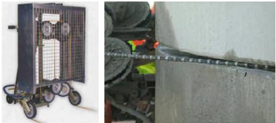
Figure 11: à gauche : Scie à câbles, avant le vissage sur la section / à droite : Commande hydraulique de la scie par une commande à distance
