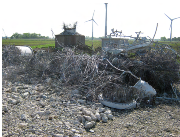
Figure 17: Armature en béton et en acier séparée
