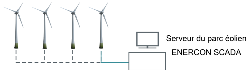
Fig. 13: Interruption d'une partie du bus de données sans management annulaire.
